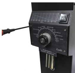
图9.2-拆除刻度盘前盖
