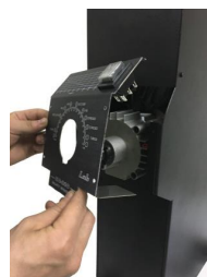
图9.3-标记并拆除连接线
