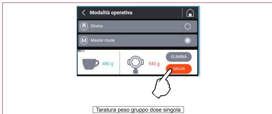
Appoggiando il portafiltro sulla forcella, la macchina rileva in automatico il peso del portafiltro utilizzato e procede ad erogare la quantità di caffè impostato.
